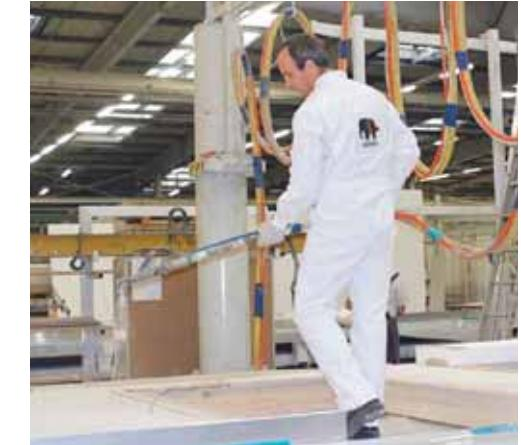
industrijskog nanošenja povezanih sustava za toplinsku izolaciju u proizvodnji montažnih odnosno gotovih kuća
