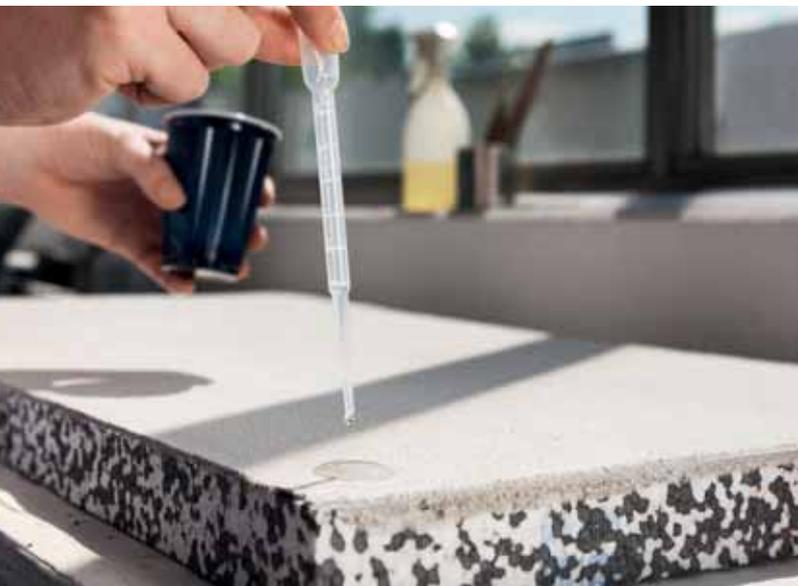
Vodoodbojnost: žbuka na fasadnim termoizolacijskim pločama Capatect Dalmatiner zadovoljila je visoke zahtjeve ispitivanja
