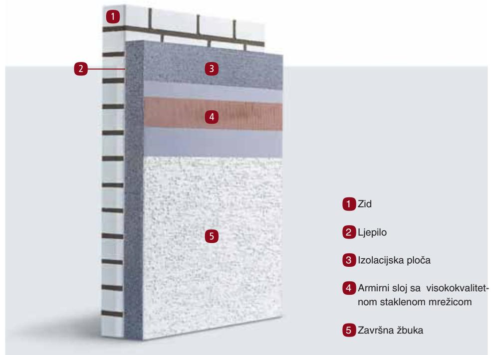
Sustav za toplinsku izolaciju sastoji se od izolacijskog materijala i različitih vrsta završnih slojeva.
