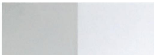
**Uzorak izložen atmosferilijama na zgradi u Istanbulu nakon dvije godine testa postojanosti:** konvencionalna fasadna boja (lijevo) je značajno jače posivila od fasadne boje sa nano-quarz gitter tehnologijom.
