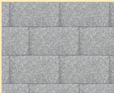
Lijepljenje izolacijskih ploča mora se uvijek izvesti prema okomito postavljenim spojnim fugama i potrebno ga je odgovarajuće prilagođavati obliku ploča. Križne fuge nisu dopuštene.
