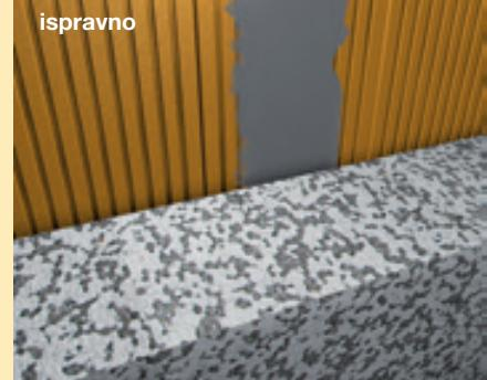
**Protupožarna brana:** na zgradama s više od 3 nadzemna kata treba u slučaju primjene izolacijskih materijala razreda C, D ili E u debljine veće od 10 cm dokazati da se u slučaju požara poštuju zahtjevi i zaštitne mjere sukladno normi ÖNORM B 3800-5. Ovo u svakom slučaju vrijedi kao ispunjeno, ako je u području nadvoja prozora i prozorskih vrata izvedena protupožarna brana od mineralne vune (MW-PT) s dodatkom od 30 cm sa svake strane i visinom od 20 cm, s pričvrstnicama.
