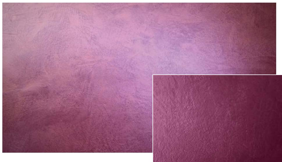
Jako zaglađenim i intenzivno obojanim premazom podloge sa Amphibolinom, ova tehnika postiže svoju dubinu i jačinu izražaja. Glatka obrada tih dvaju materijala osigurava maksimalni efekt izmjene boja *switch* pigmenata. Tako se površina ističe intenzivnim koloritom i dojmljivom izmjenom nijansi ovisno o kutu promatranja i pada svjetla. Kao i kod svih premaza sa svjetlucavim ili blještavim efektima, takva površina živi od pravilnog postavljanja u spoju sa svjetлом.
